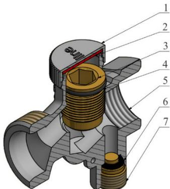
Рисунок 6 – Устройство клапана
