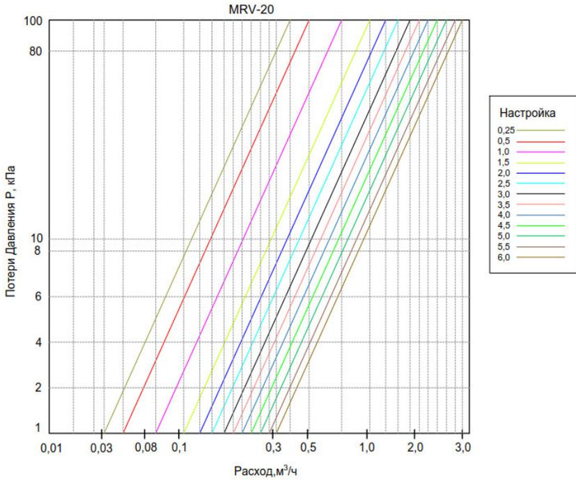
Рисунок 3 – Гидравлические характеристики ручного запорно-регулирующего клапана MRV-20
