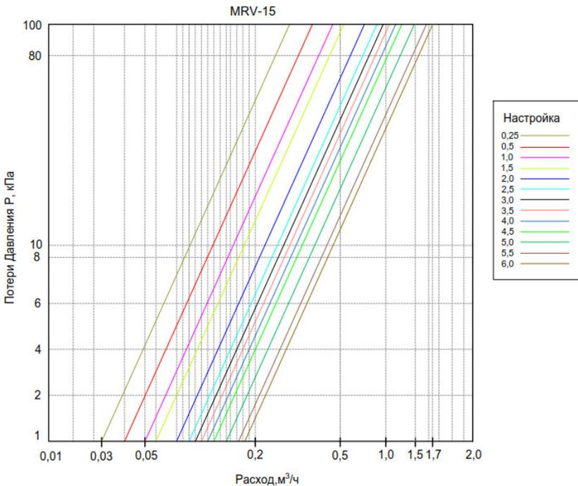
Рисунок 2 – Гидравлические характеристики ручного запорно-регулирующего клапана MRV-15
