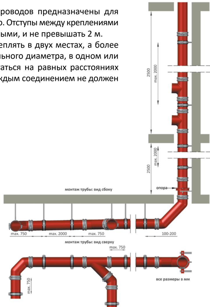
Общая схема монтажа системы Sanline SML
