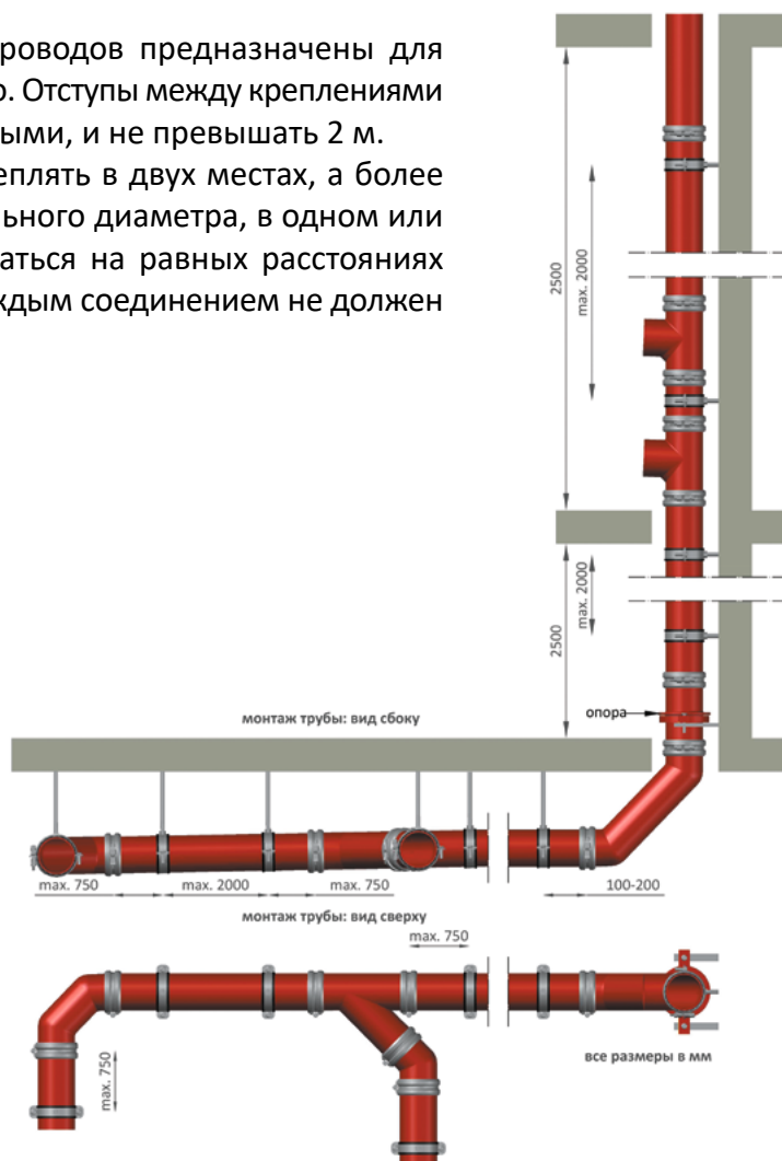
Общая схема монтажа системы Sanline SML
