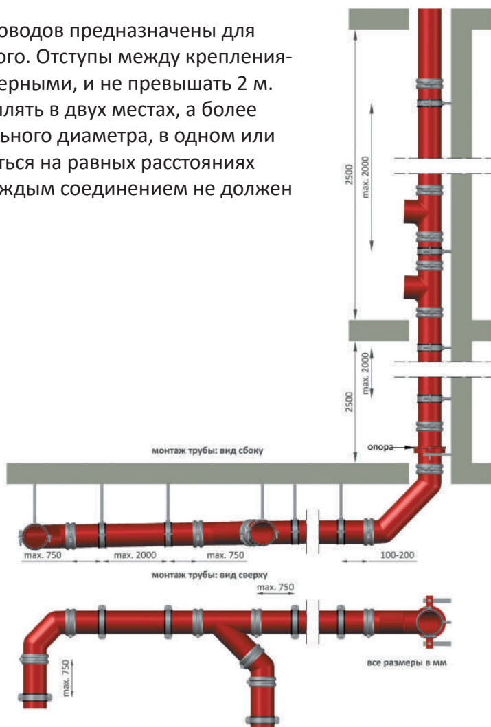
Общая схема монтажа системы Sanline SML
