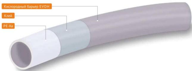
Материал труб – сшитый полиэтилен (PE-X) – получают путем сшивки полиэтилена (PE). Исходным сырьем является высокомолекулярный полиэтилен высокой плотности с линейной структурой и повышенной прочностью. По этой причине уже сам исходный материал характеризуется высокой ударной прочностью и ударной вязкостью. Для сшивки полиэтилена используются различные методы.
